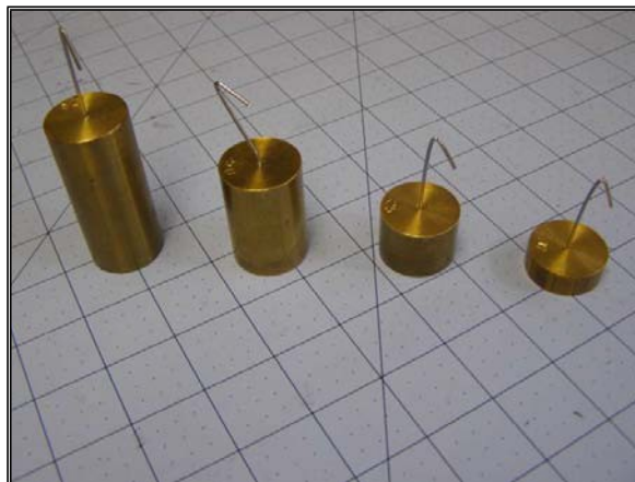
图 42. 确定焦痕长度的砝码
