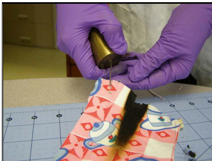
图 37. 将砝码挂在样本上
