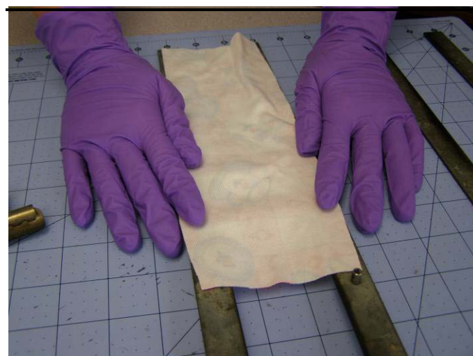
图 19. 将样本放在样本夹背板上
