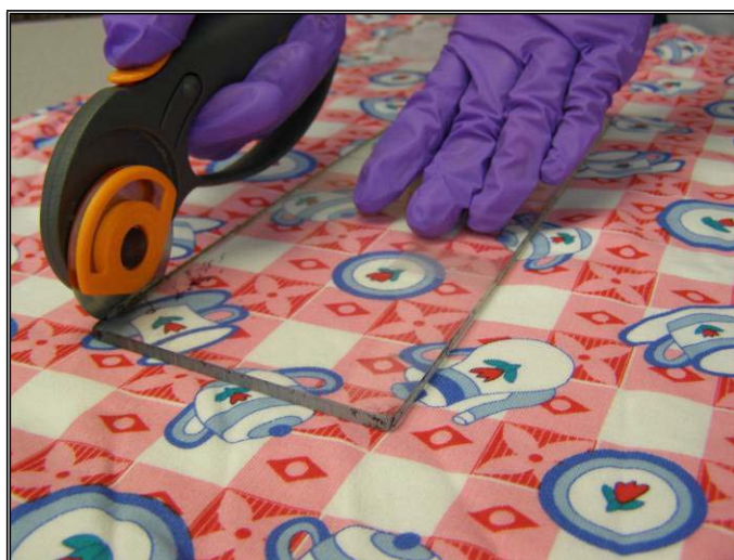
图 15. 使用模板制备面料样本
