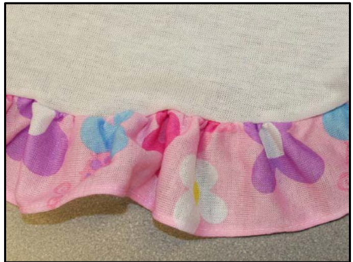
图 50. 将褶裥饰边作为镶边检验
