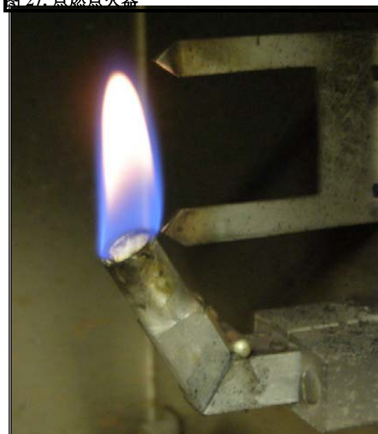
图 28. 检查火焰长度
