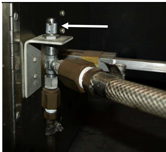
图 29. 使用燃料阀调节火焰长度
